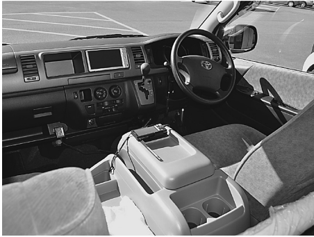
写真2 三重県玉城町で採用されたシステムBの車載器（運転席シートの左）コンパクトな画面で運行・予約状況などを指示
